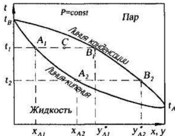
Рис. 19.1. Диаграмма фазового равновесия в системе «жидкость-пар» для идеальной смеси
